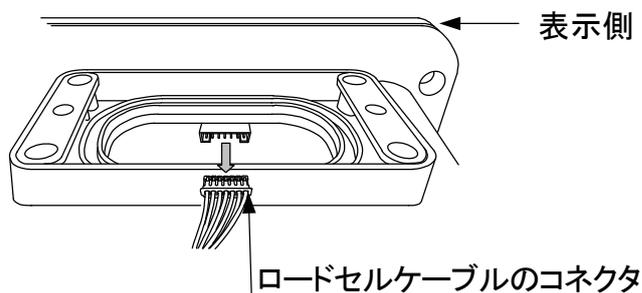
4. ロードセルケーブルをケーブルクランプに固定している結束バンドを切断します。
