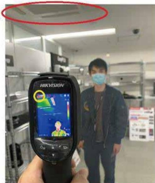
カメラは人物より温度の高い送風口（カメラ画面の黄色○内の十字）の温度を測定してしまう。画面内の最高温度の場所の温度を測定するため、高温のものを撮影範囲内に入れないこと。（例）の画像ではエアコンが画面内に入っているため、人物の温度測定はできない。
