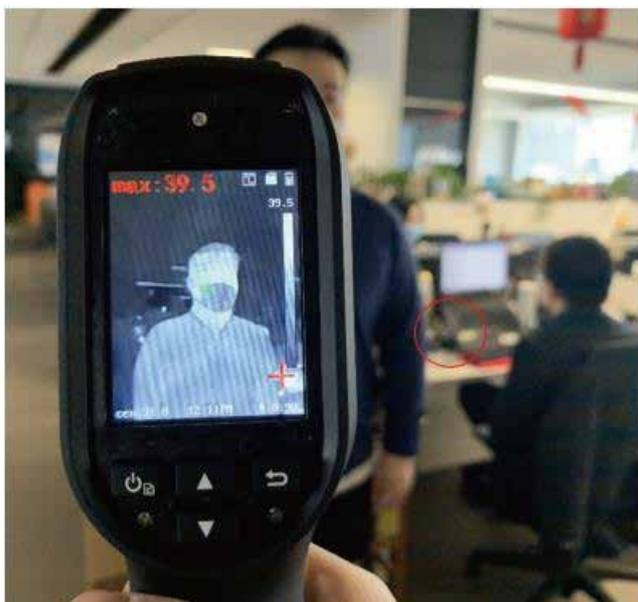
(例) ではモニターが近くにあり人物の温度測定に影響を及ぼして測定温度が高めに出てしまっている。エアコン温風などの風、モニターや PC 等の発熱する機器等を測定対象人物の近くに置かないこと。また、直射日光が当たる場所なども日光により壁等の温度が上がるため精度が下がり、使用場所としては推奨しない。
