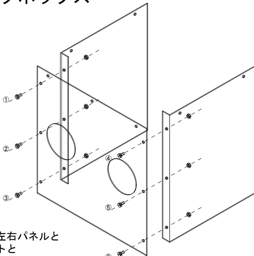
右記図参照の上、側面左右パネルと正面パネルをプラボルトとプラナットで①～⑥を固定してください。
