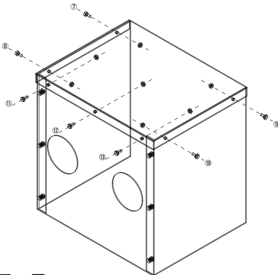
右記図参照の上、本体と天面パネルをプラボルトとプラナットで⑦～⑬を固定してください。
