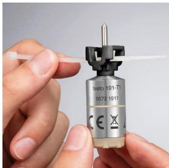
4 データロガーを金属製のかご等に括り付けてしっかりと固定します。
