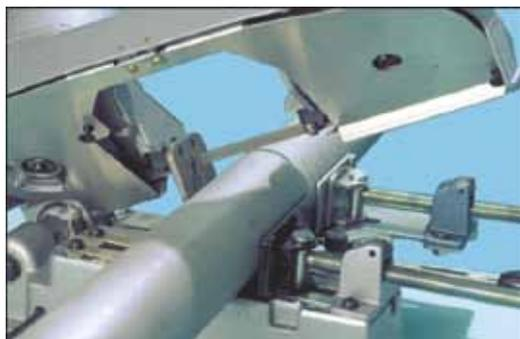
①パイプ切断寸法表によりメタルソー、バンドソー切断機等を用いパイプを軸心に直角に切断する。
