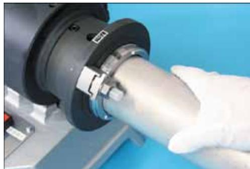
②貫通フランジBをヨークに挿入し、フランジ押さえで固定する。六角ナットは付属の片口スパナでしっかりと締付けてから拡管してください。
