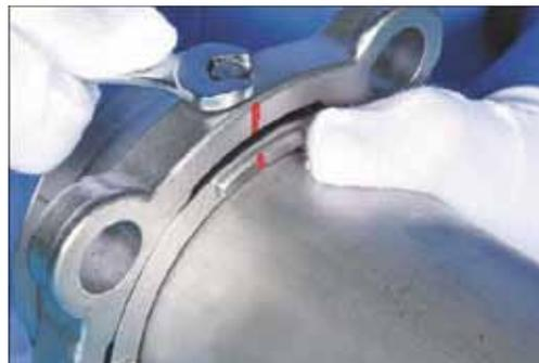
⑤貫通フランジAと貫通フランジBの合印を合わせ組み込み、付属の六角ボルトをスパナ等でしっかりと締め付ける。
