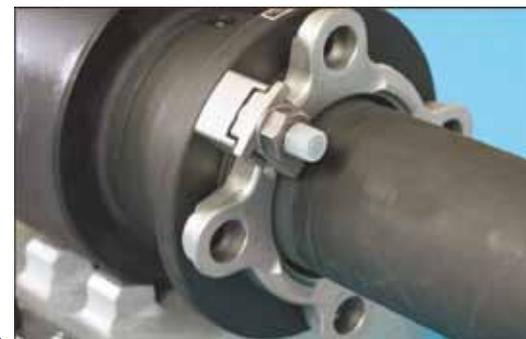
③フランジをヨークに挿入し、フランジ押さえでフランジを固定する。
