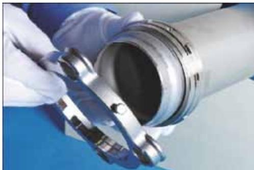
④通した貫通フランジBに貫通フランジAを組み込む。
