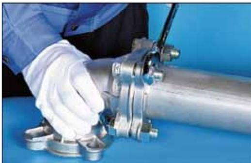
⑩締め付けは対角線上にフランジ面が本体に密着するまで締め付けてください。
