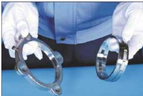
①貫通フランジを貫通フランジAと貫通フランジBに分解する。
