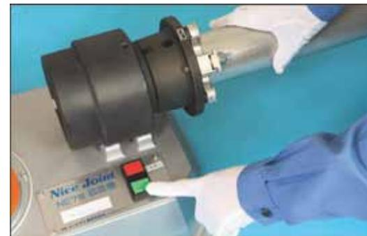
⑥拡管はスイッチ「運転」を押す。拡管が完了し2秒間保持した後モーターが停止しガイドロッドが復帰します。「非常停止」は緊急停止時のみ使用します。
