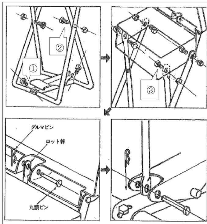
3. ロッド棒を蓋にとりつけてください。(丸頭ピンの先端の小穴へダルマピンを通します。)
