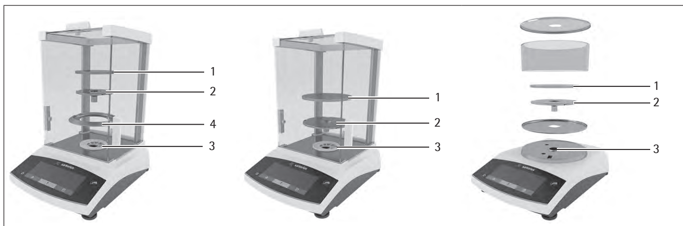
図3: 分析風防付き分析天びん、分析風防付き精密天びん、ラウンド風防付き精密天びん(例)
