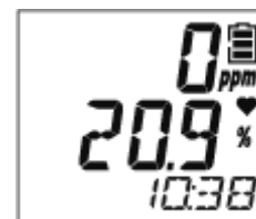
上段: CO(一酸化炭素)の ガス濃度表示 中段: O2(酸素)の ガス濃度表示
