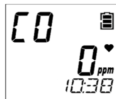
CO(一酸化炭素)の ガス濃度表示
