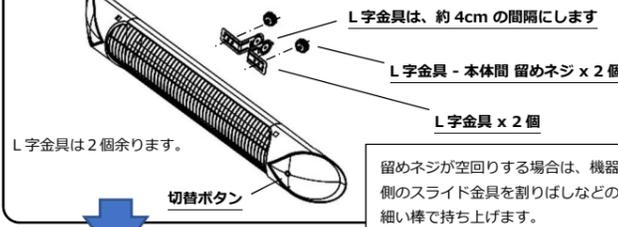
手順②B-1：機器本体に縦向き取付用専用金具を取り付けます
