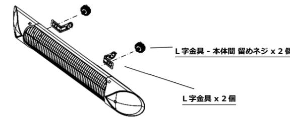
手順②：壁・天井に、L字金具を取り付けます
