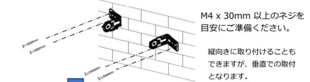
手順③：機器側と、壁・天井側の L字金具 同士を取り付けます
