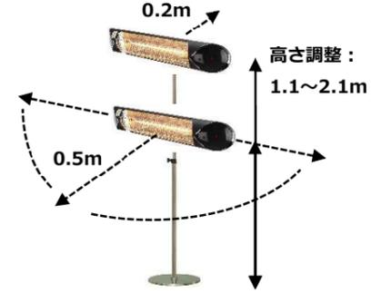
図：スタンド設置の場合の離隔距離
