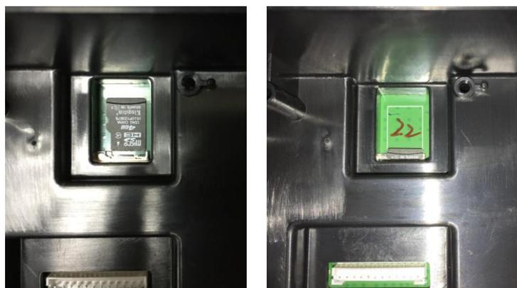
図 2-5 マイクロ SD ソケットへの マイクロSD カードのスライド (左)、SD カード取り付け済み (右)
