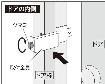
取付金具をドア枠にはめ、ツマミを回してドア枠にしっかりと固定し、ドアを閉めるときに取付金具とドアが当たらないか確認します。
