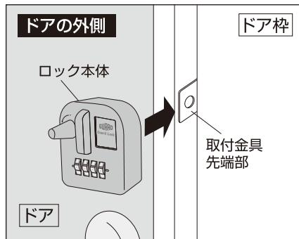
ドアを閉めて、取付金具先端部にロック本体をセットし、施錠できるか確認します。
