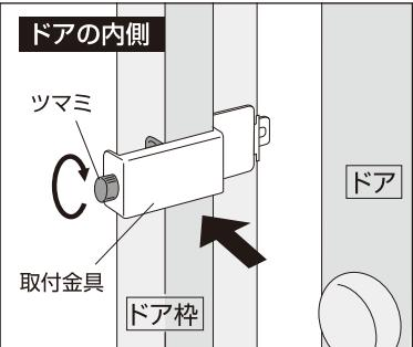
取付金具をドア枠にはめ、ツマミを回してドア枠にしっかりと固定し、ドアを閉めるときに取付金具とドアが当たらないか確認します。
