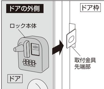
ドアを閉めて、取付金具先端部にロック本体をセットし、施錠できるか確認します。
