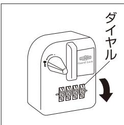
**施錠方法** ①開錠状態のロック本体を取付金具の出っ張りに差し込み、ツマミを左に回します。
