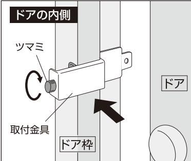
取付金具をドア枠にはめ、ツマミを回してドア枠にしっかりと固定し、ドアを閉めると同時に取付金具とドアが当たらないか確認します。
