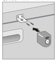
扉や引き出しがしっかりロックされる位置を確認し、L字金具を枠にネジ 止めします。
