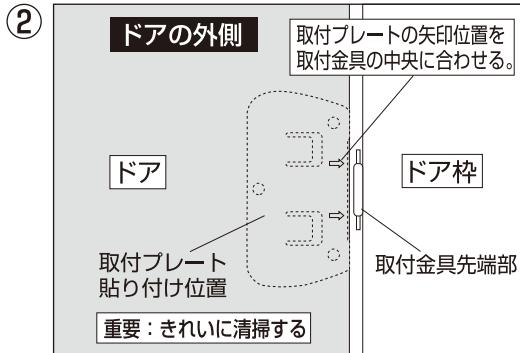
②取付金具を付けたままドアを閉め、取付プレートの矢印を参考に取付プレートの貼り付け位置を確認し、必ず取付位置のドア表面の汚れをきれいに除きます。
