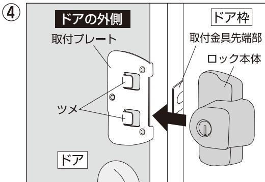
④取付プレートのツメに掛かるようにロック本体を装着して完了。
