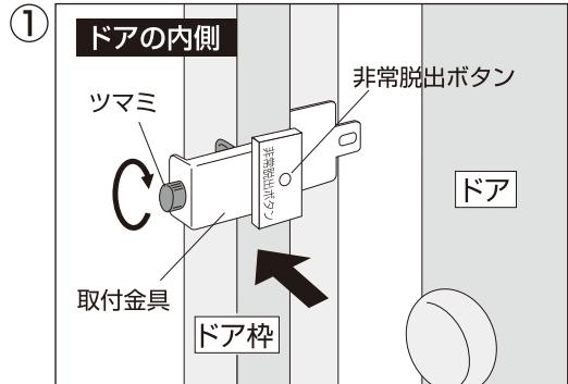
①取付金具をドア枠にはめ、ツマミを回してドア枠にしっかりと固定し、ドアを閉めるときに取付金具とドアが当たらないか確認します。
