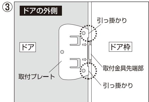
③取付プレート裏の両面テープをはがし、取付プレートの矢印と取付金具先端部が合うように貼り付けます。この時、取付プレートにある2ヶ所の引っ掛けりが扉の角にピッタリ合うように押しつけてください。
