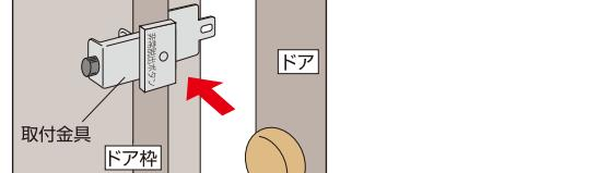
ドアの外側 取付プレート 取付金具先端部 ドア枠 ロック本体
