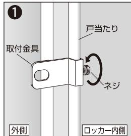
扉を開けて取付金具をロッカーホルダの戸当たりにはさみ、固定ネジを回して取付けます。
