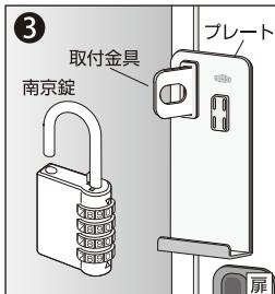
飛び出た取付金具の先端部にプレートを差し込みます。プレートには扉の接地面にゴムマグネットが付いていますので、その位置で固定されます。取付金具の穴に南京錠をロックして施錠完了です。
