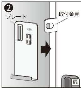
扉を閉めて、取付金具が当たらないか確認する。扉を閉めたとき、取付金具の先端部が左図のように飛び出た状態になります。
