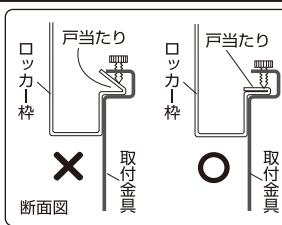
ロッカーホルダにより戸当たりの折り返しが大きい場合があります。そのまま固定しますと取付金具の緩みや落下の原因になりますので、イラストを参考に、取付金具の接地部分をペンチなどで押しつぶして、しっかりと固定してください。
