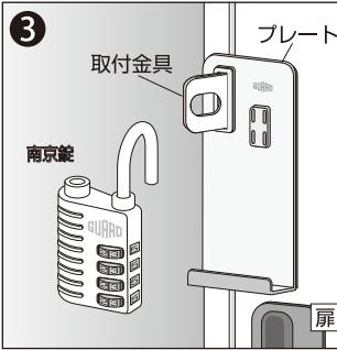
飛び出た取付金具の先端部にプレートを差し込みます。プレートには扉の接地面にゴムマグネットが付いていますので、その位置で固定されます。
