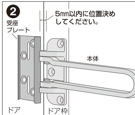
受座のネジをゆるめて、受座プレートから外します。受座プレートの裏側に仮止めシールを貼り付けます。
