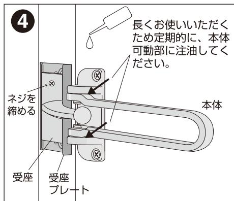
受座を受座プレートに取り付け、ネジを締めて完了です。
