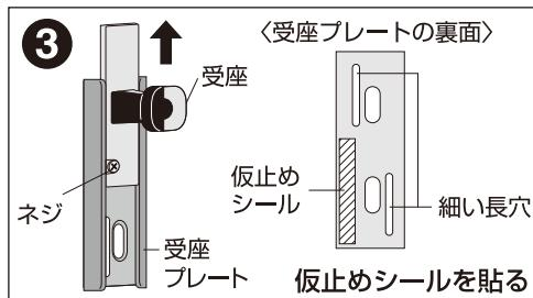
ネジをゆるめて受座を外します。受座プレートの裏側に仮止めシールを貼り付けます。
