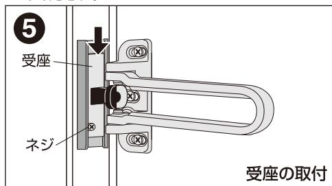
受座を受座プレートに差し込み、緩めたネジを締めて完了です。
