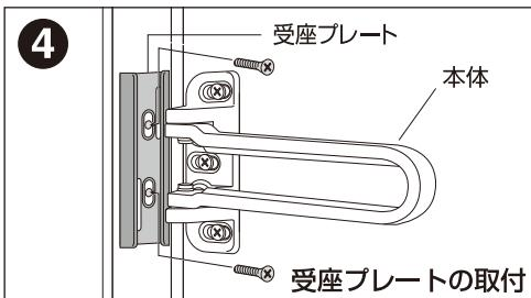
元のネジ穴の位置に合わせて仮止めした受座プレートをネジ止めしてください。
