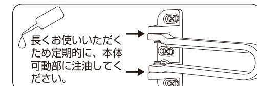
※受座プレートの取付ネジはネジ頭がプレート面より下がるように設計されていますが、ネジ穴部に金属片、ゴミなどが付着していると正確なネジ止めができず、受座の動きが悪くなりますのでご注意ください。
