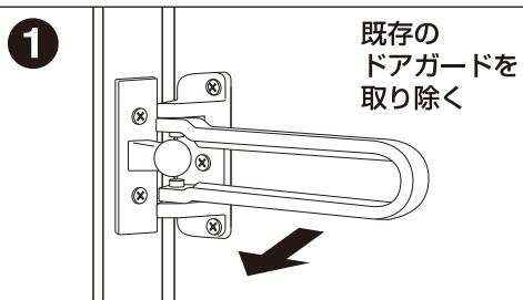
現在お使いの本体と受座のネジをドライバーで外し、既存のドアガードを取り除く。
