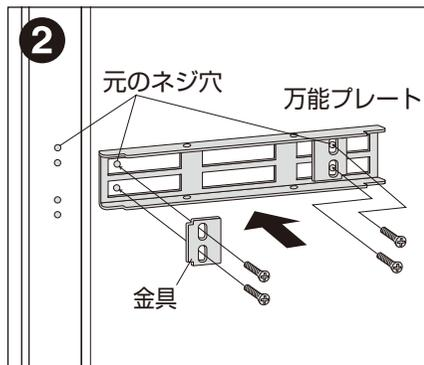
外した後のネジ穴に万能プレートを当て、金具をはめ込み、ネジ止めしてください。
