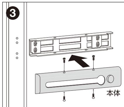
万能プレートをネジ止めしたら、本体をはめ、上下4箇所をネジ止めします。
