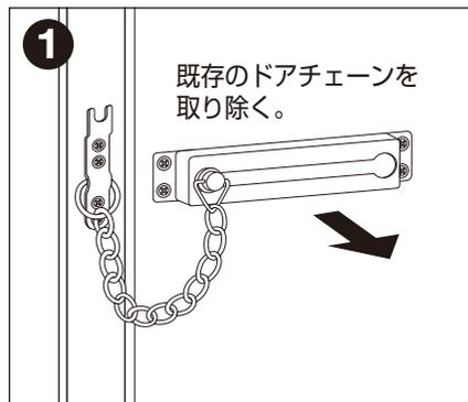
現在お使いのドアチェーン・チェーンホルダーのネジをドライバーで外します。
