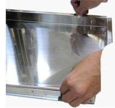
③摘んだ状態のまま、プレートを持ち上げてロッククリップ穴から引き抜きます。
