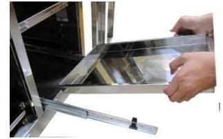
④ロッククリップを抜いたプレートは、取り外して下さい。
