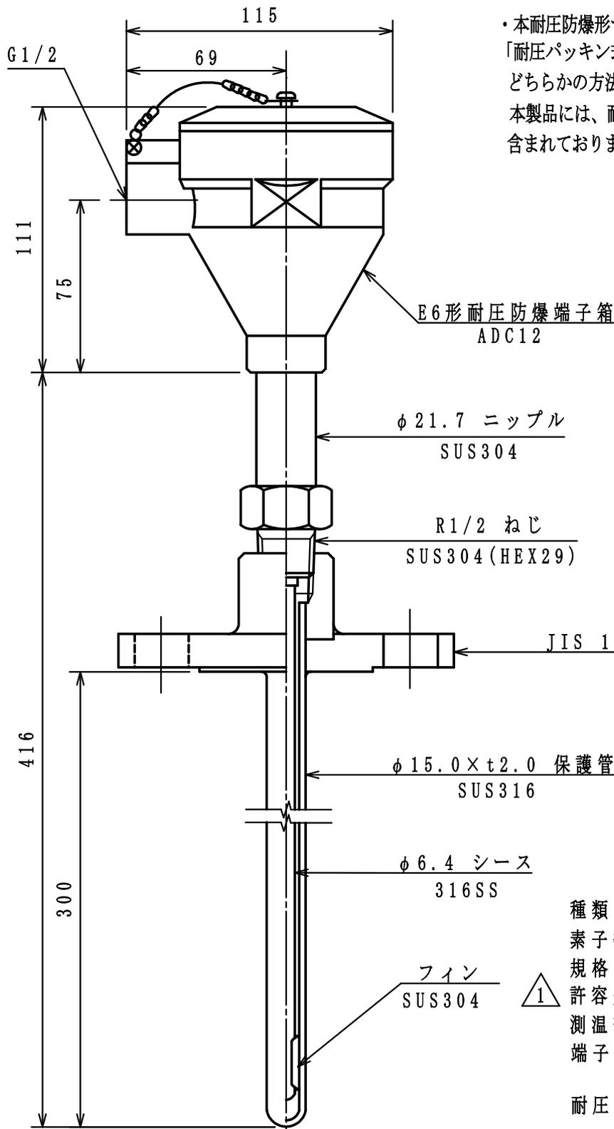
・本耐圧防爆形センサーの外部導線の引き込み方式には、「耐圧パッキン式」と「電線管耐圧ねじ結合式」があり、どちらかの方法で外部導線を結線する必要があります。本製品には、耐圧パッキン等の接続金具や外部導線は含まれておりませんので、ご注意ください。
