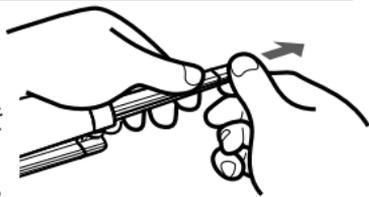
2. パイプの凸部とノズルの凹部を合わせ、
