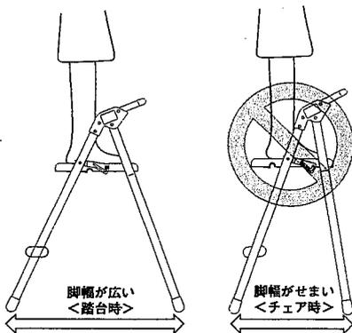
・天面に立つ際には、製品に対して横向きに立つことは絶対にしないでください。天面の変形や破損により、転倒やケガをする恐れがあります。
