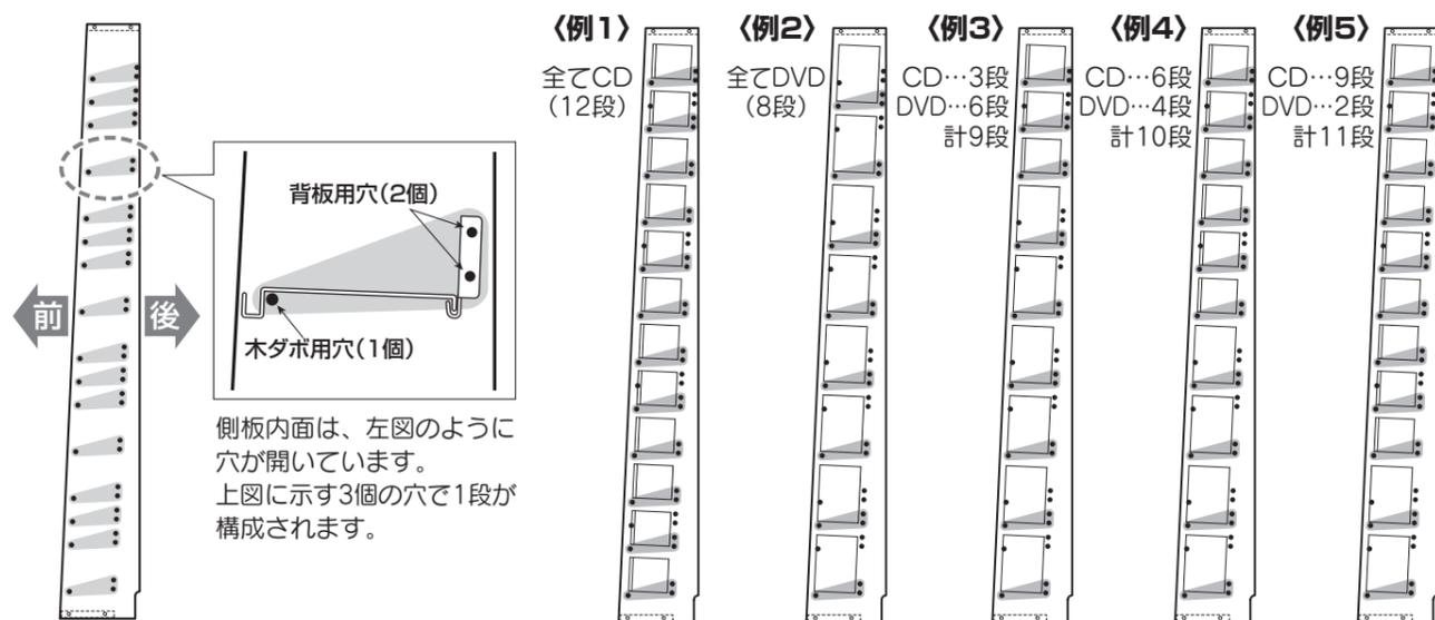
**2** 両側板の内側・前方の穴に**1**で決めたパターンに合わせて⑧木ダボを打ち込んでください。
