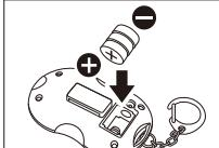
①本体裏面の電池カバーのネジをはずす
