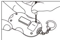
④カバーを取り付け、はずれないようにネジをしっかりと締める
