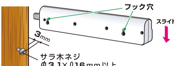
1.呼び径3.1、長さ16mm以上のサラ木ネジを、ネジ頭の長さが3mmになるまでねじ込みます。
