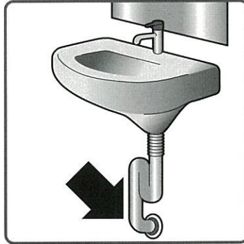
● 台所・浴室・洗面所の配管・排水 管取付け部と壁面や床面のすきま の充てん。
