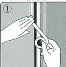
周囲のはみ出しを防ぐために、補修箇所の両側にマスキングテープを貼ります。
