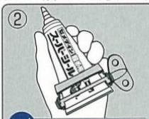
添付のノズルをすき間にあわせてカットし、チューブに取り付けます。チューブ・しぼり器にチューブ尻部を差し込んでセットします。
