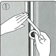
① 周囲のみ出しを防ぐために、補修箇所の両側にマスキングテープを貼ります。
