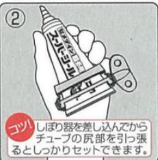
② 添付のノズルをすき間にあわせてカットし、チューブに取り付けます。チュープしぼり器にチュープ尻部を差し込んでセットします。
