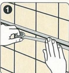
周囲のはみ出しを防ぐために、補修箇所の両側にマスキングテープを貼ります。
