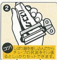
添付のノズルをすき間より少し太めにカットし、チューブに取り付けます。図のようにチューブ・しごり器にチューブ・ノズルを差し込みます。
