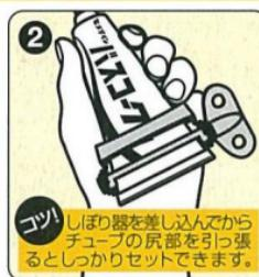
添付のノズルをすき間より少し太めにカットし、チューブに取り付けます。図のようにチューブ・しづらり器にチューブ尻部を差し込みます。
