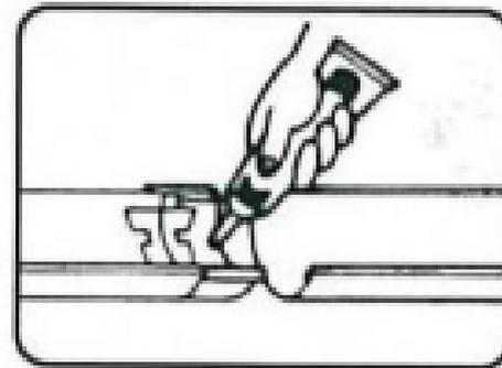
①接着する面のゴミ・サビ・油などの汚れを落とし、よく乾燥させ、両面に均一にうすく塗ります。
