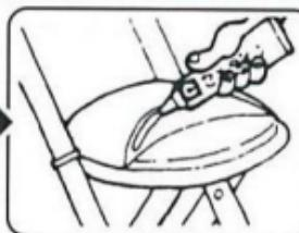
接着する両面に均一にうすく塗り、1~2分乾かしますが、表面が乾燥しない間に貼り合わせます。
