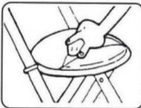
接着面のゴミ・サビ・油などの汚れを落とし、よく乾燥させます。
