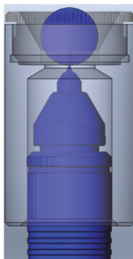
図 4-6 ディスクとチゼルウエアチップのエッジの位置合わせ
