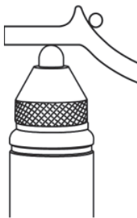
図 414 不正確な厚さ測定の場合： ターゲットボールが障害物により正しく接触していない
