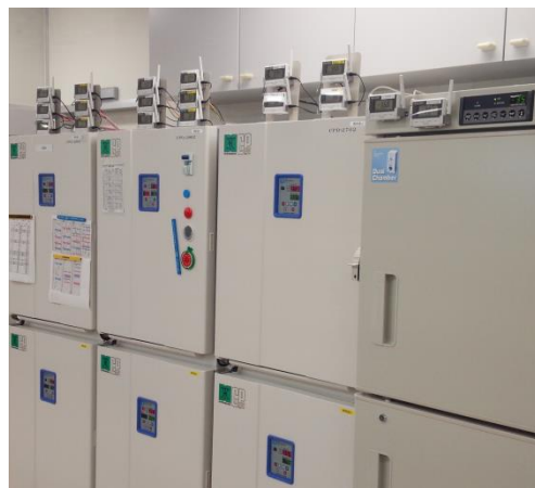
インキュベータへの設置状況 庫内温度に加えてCO 2 、O 2 濃度もワイレスウォッチャで一元管理
