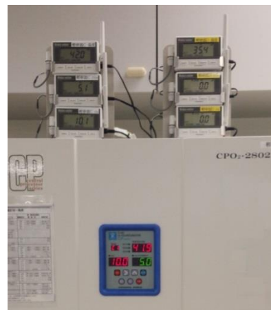
インキュベータへの設置状況 庫内温度に加えてCO 2 、O 2 濃度もワイレスウォッチャで一元管理
