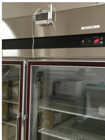
冷蔵庫への設置状況 マグネット付取付ホルダーで装置に固定
