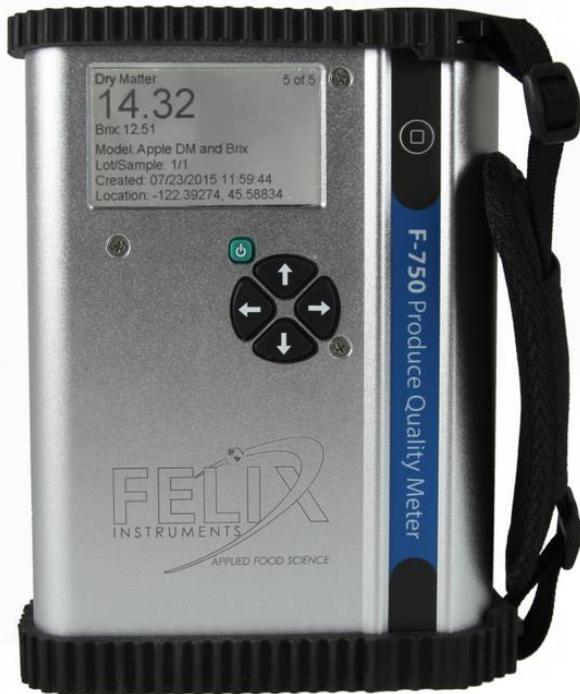
焦電型赤外線センサーを利用し、非破壊で農産物の内部状態を一括にチェックすることができます。
