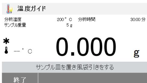
指示に従ってサンプル受け皿をセットし、ハウジングを閉じ、風袋引きを実行します。
