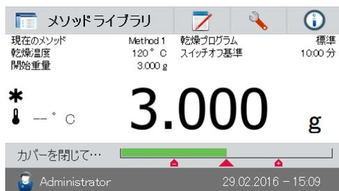
重量確認バーに、サンプルの重量が示されます。
