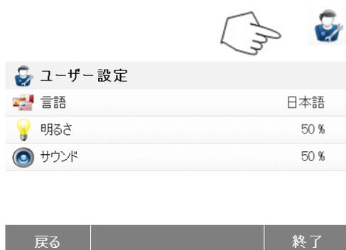
ユーザー設定 を押して、ユーザー設定メニューにアクセスします。
