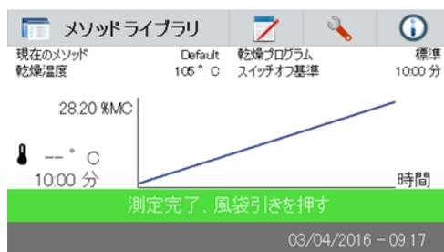
画面には、メソッド名、温度/時間、実際の温度、測定過程経過時間、水分含有量及び曲線が表示されます。テストは自動的に測定が終了した時点で止まります。
