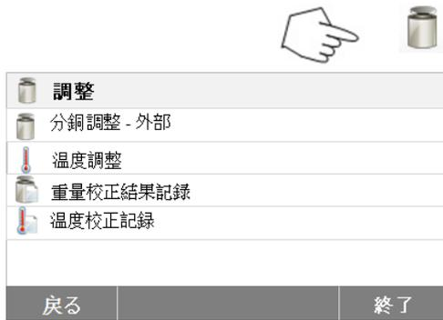
分銅と温度校正 ボタンを押して、校正メニューにアクセスします。
