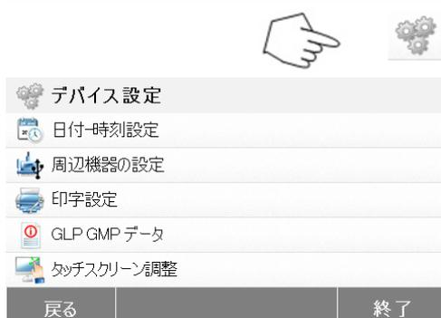
**デバイス設定** ボタンを押して、デバイス設定メニューにアクセスします。
