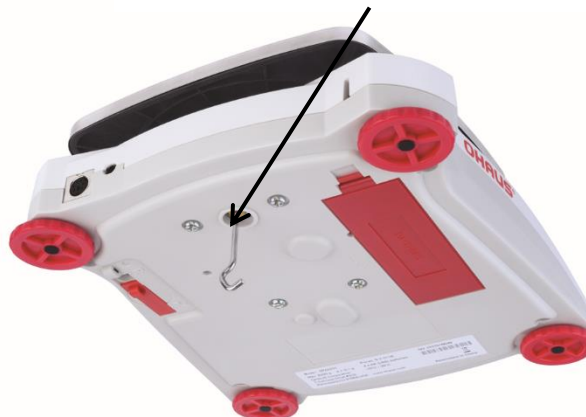
取り付けられた床下計量フック
