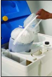
活性炭バッグの 抜き出し状況
