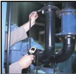
ガスが配管からリークする際に、配管との摩擦で40kHz帯の超音波が発生します。「CS-530」は、同周波数帯の超音波を検知し、非接触でエアリークを発見することが可能です。また、40kHz帯のみ検出を行いますので、工場稼動中機器の騒音がある環境でも効率的にリークを発見することができます。
