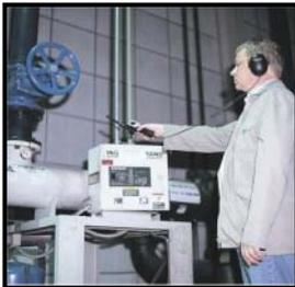
オプションの超音波トーンジェネレーターを利用した簡易密閉度検査(シール検査)にもご利用いただけます。水没試験よりも手軽にシール検査が可能です。
