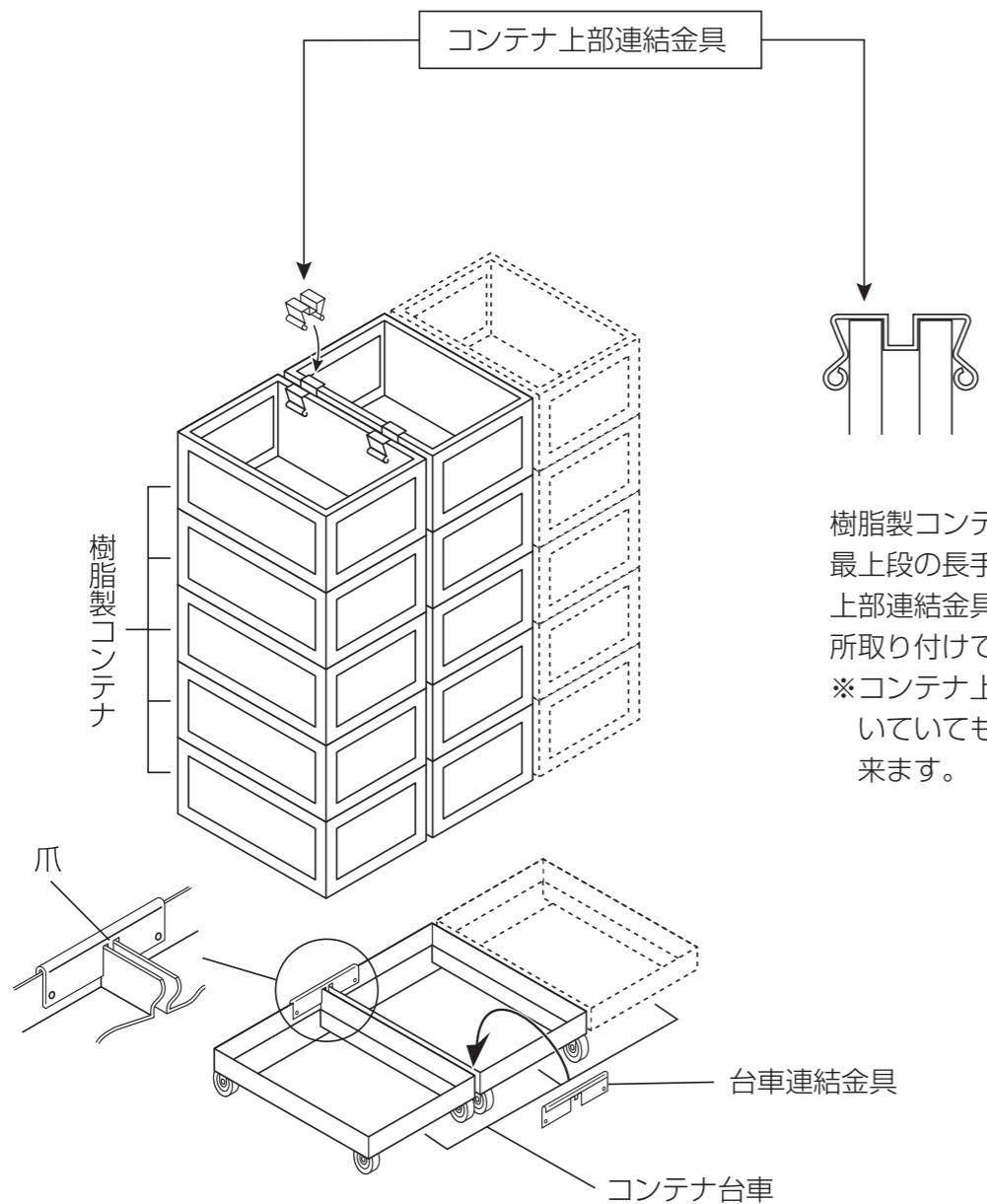
樹脂製コンテナ同士の連結は最上段の長手側面にコンテナ上部連結金具を図の様に2ヵ所取り付けて下さい。
