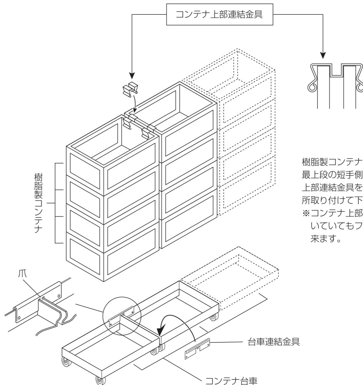
樹脂製コンテナ同士の連結は最上段の短手側面にコンテナ上部連結金具を図の様に2ヵ所取り付けて下さい。
