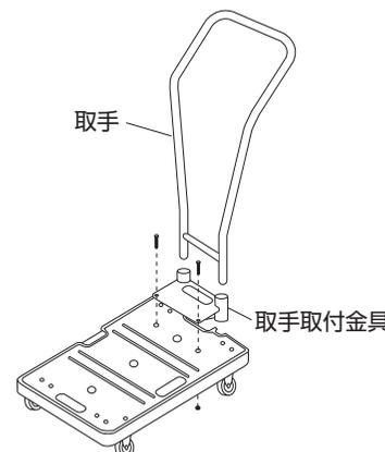
台車に取手取付金具を差し込み、六角ボルト、フランジナットで取り付けて下さい。取手を、パイプの中に差し込んで下さい。
