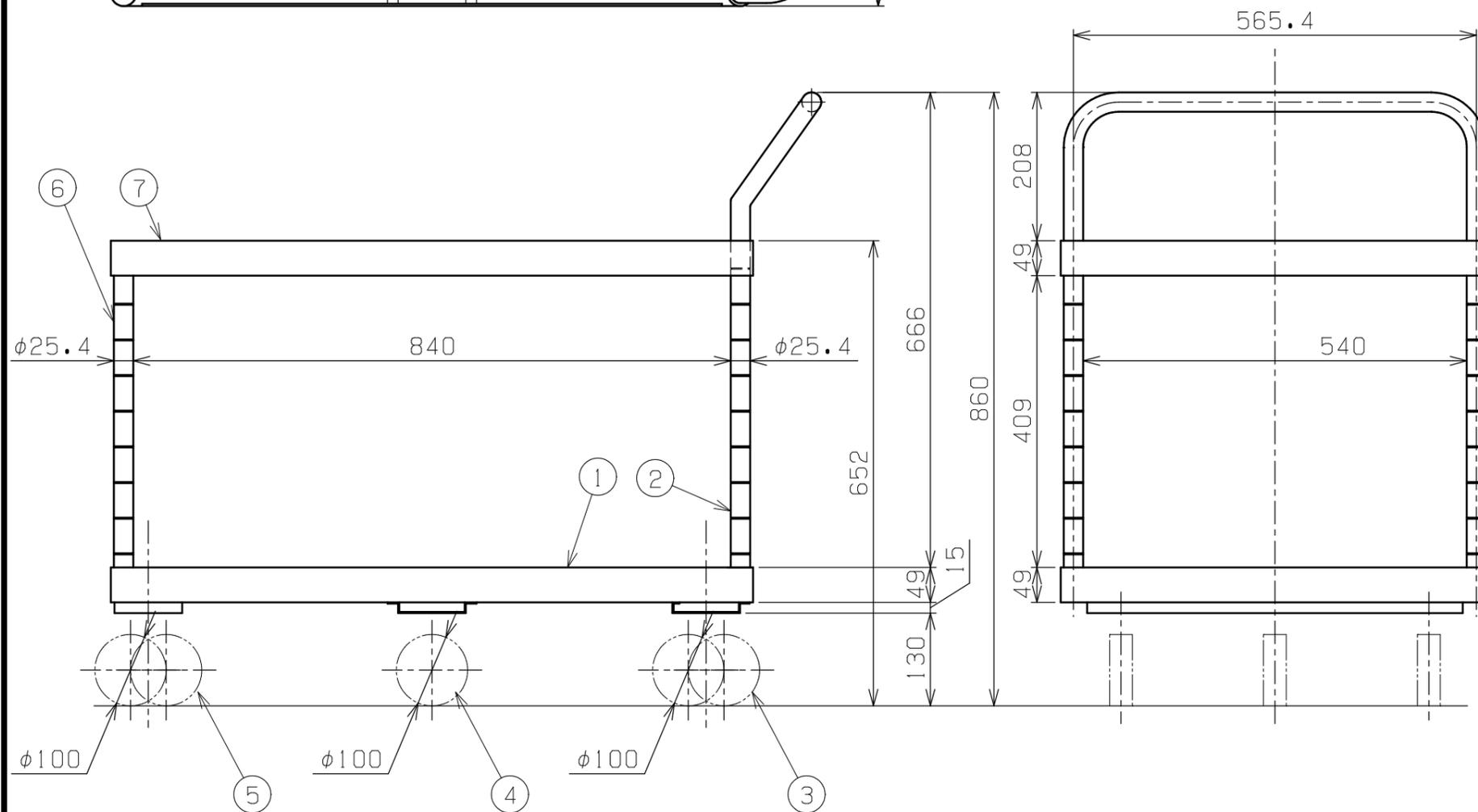
上荷台形状：フラット型・皿型組替自在（コボレ止め高さ47mm）
