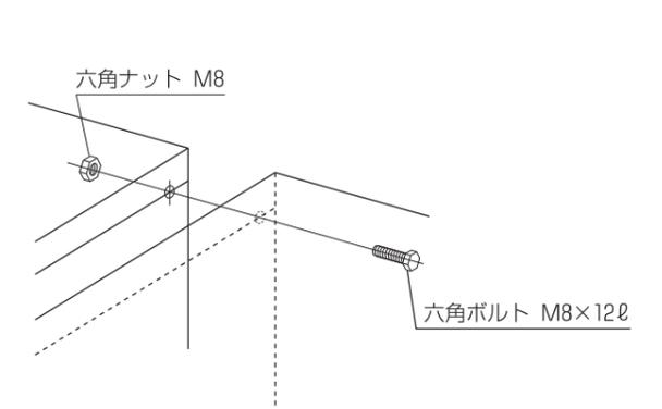
※保管庫と保管庫は、図の如くボルトで固定して下さい。
