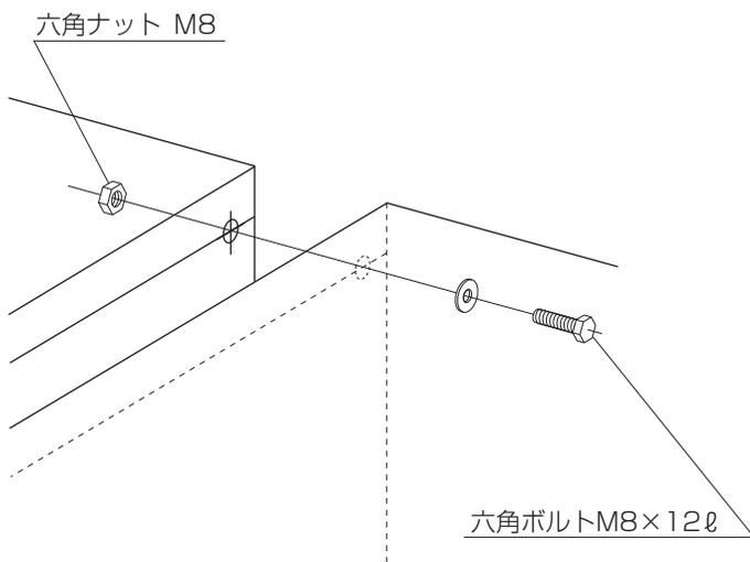
※保管庫と保管庫は、図の如くボルトで固定して下さい。
