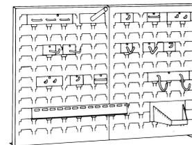
積載荷重は、製品の耐荷重の範囲内にして下さい。それ以上載せたり、荷重が片寄りますと製品破損の恐れがあります。
