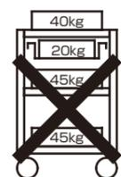
床面は平坦なコンクリートでツールワゴン1台当りの均等耐荷重を棚板の枚数で割った重量を上限に各段均等にお載せ下さい。
