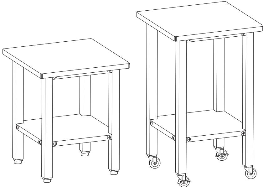
積載荷重は、製品の耐荷重の範囲内にして下さい。それ以上載せたり、荷重が片寄りますと製品破損の恐れがあります。
