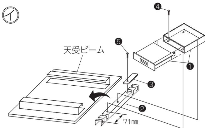
① 任意の位置にキャビネット吊金具②を図の様にセットします。奥行750,900タイプは浮き上がり防止のためにキャビネット吊金具の後ろに止め金具③、トラス小ネジ⑤で本体とキャビネット吊金具を固定して下さい。さらにキャビネット①の引出しを抜き、キャビネット本体を裏返してキャビネット吊金具の上に置き、六角アプセットセムス④で仮止めます。
