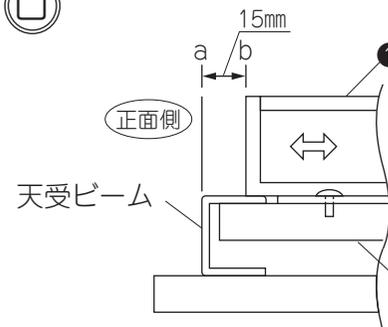
② 本体を図中のb地点に本体の前面が来るように合わせます。そしてキャビネットが動かないよう本締めして下さい。その後本体を起こしてキャビネット①の引出しをキャビネットに戻します。
