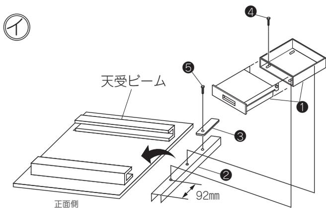
① 任意の位置にキャビネット吊金具②を図の様にセットします。奥行750,900タイプは浮き上がり防止のためにキャビネット吊金具の後ろに止め金具③、トラス小ネジ⑤で本体とキャビネット吊金具を固定して下さい。さらにキャビネット①の引出しを抜き、キャビネット本体を裏返してキャビネット吊金具の上に置き、十字穴付六角ボルト④で仮止めます。
